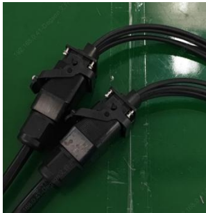
图20 湿热测试后外观
