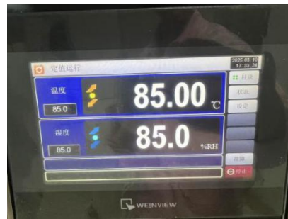
图19 湿热测试设置
