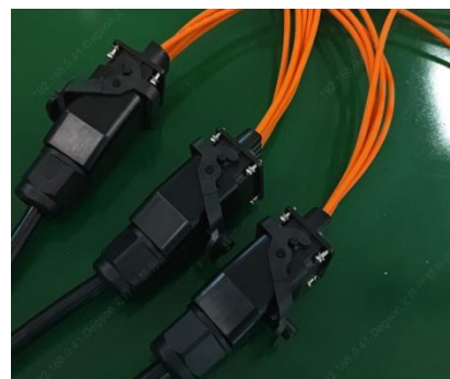
图13 温度循环后样品外观
