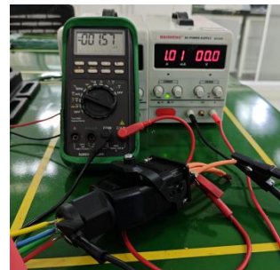
图33 气候试验后接触电阻测试
